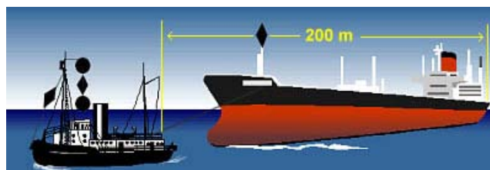
Remorqueur tractant un navire. La longueur du train de remorque dépasse 200 mètres. Capacité de manoeuvre restreinte.
