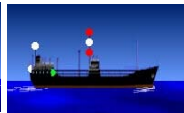
Navire de moins de 50m en route à capacité de manoeuvre restreinte.
