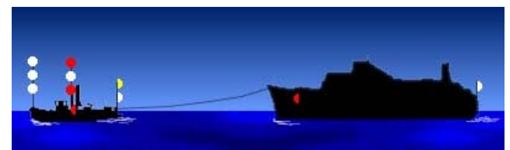
Navire remorqué et remorqueur en route (à capacité de manoeuvre réduite) dont la remorque dépasse 200m.
