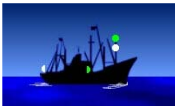
Chalutier de moins de 50m en route et en pêche vu du côté tribord.
